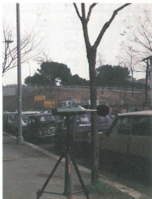
Fonometro per la misura dei livelli di rumore. Nella pagina accanto: barriere antirumore in legno sull'A1 nei pressi di Casalecchio.
